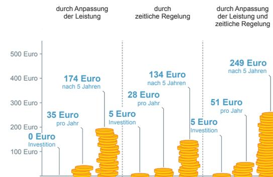
Das Anpassen der Leistung der Heizungspumpen sowie deren zeitliche Regelung kostet Sie nichts bzw. höchstens 5 Euro für eine Zeitschaltuhr und kann Stromkosten von etwa 51 Euro pro Jahr einsparen. Daraus ergibt sich in fünf Jahren eine Gesamteinsparung von 249 Euro.
